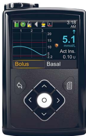
Инсулиновая помпа Medtronic MiniMed 640G с функцией непрерывного мониторинга глюкозы в реальном времени SmartGuard
